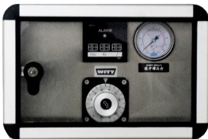
Рис2. Панель регулировки консервирующего газа.
